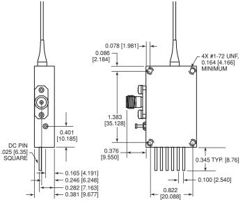
APPLY ALL VOLTAGES SIMULTANEOUSLY, OR IN THE FOLLOWING ORDER: • +5V • -12V
